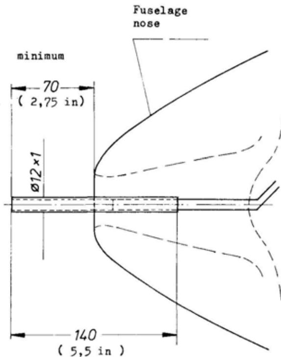
Tubo di prolunga della presa di pressione totale per l'uso in volo rovescio. Tubetto di ottone lungo 140 mm,  $\varnothing 12 \times 1$  mm.
